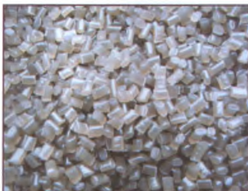
Пластмассу производят в виде гранул из которых потом отливают готовые изделия
